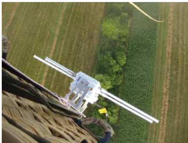
Slika 1: WLAN - zankasti usmerjevalnik, pritrjen na toplozračnem balonu, za izvajanje meritev razširjanja radijskega signala v izrednih razmerah
