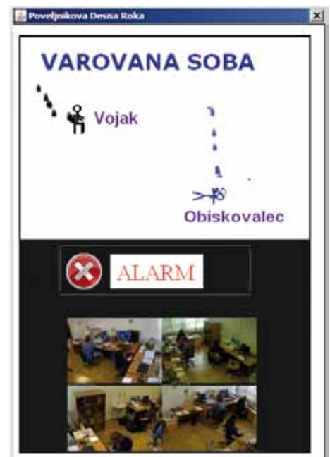
Slika 1: Nadzorna plošča inteligentnega varnostnega sistema (projekt PDR), kjer je na simbolično-grafičen način, z živo sliko ter besedilnim opisom prikazano dogajanje v nadzorovanih prostorih
