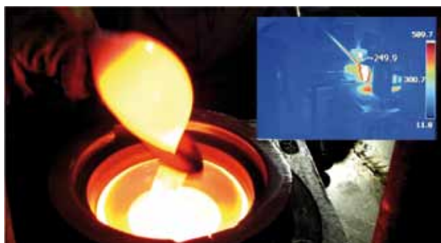
Slika 5: Analiza proizvodne faze pri izdelavi steklene stropne svetilke
