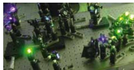
Slika 2: Nekolinearen optični parametrični ojačevalnik za generacijo sunkov, krajših od 20 femtosekund
