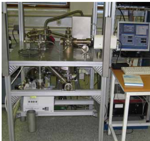
Slika 4: Novi ultraviočkovakuumski sistem za kvantitativno analizo plinskih zmesi
