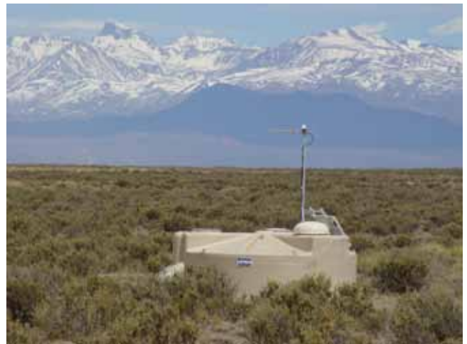
Slika 4: Talni detektor Čerenkova za površinsko detekcijo plazov nabitih delcev. Eksperiment Pierre Auger v Argentini sestavlja 1600 takih detektorjev, ki merijo svetlobne sunke, ki jih povzročijo visokoenergijski nabiti delci pri prehodu skozi vodo.
