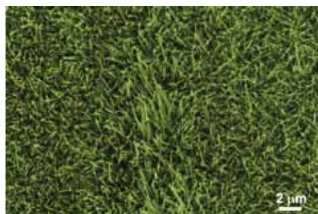
Slika 3: Nanotravniki: kristali TiO 2 -Al 2 O 3 zrastle na podlagi iz zlitine Ti6Al4V pri termični obdelavi v Ar 99,99
