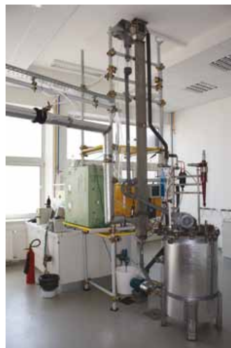
Slika 4: Laboratorijska naprava za razžvepljevanje dimnih plinov. Obnovljena laboratorijska naprava se uporablja za raziskave, ki so namenjene optimizaciji postopka razžvepljevanja odpadnih dimnih plinov v termoelektrarnah. Uporabljala se bo tudi za pilotne preizkuse odstranjevanja živega srebra iz dimnih plinov.
