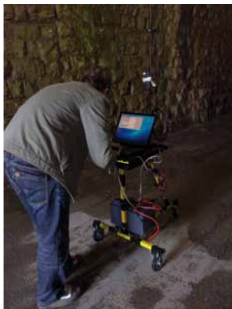
Slika 3: Meritve razširjanja radijskega signala v predoru
