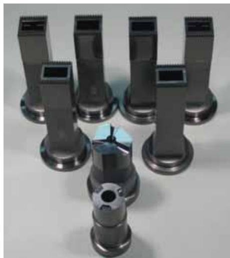
Slika 4: Orodje za stiskanje kovinskih prahov, zaščiteno s »črno prevleko«, v Uniorju, d. d., program Sinter, ga uporabljajo v proizvodnji različnih izdelkov za avtomobilsko industrijo.
