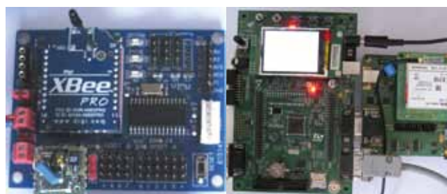
Slika 5: Merilno in centralno vozlišče dvokrožnega brezžičnega senzorskega omrežja
