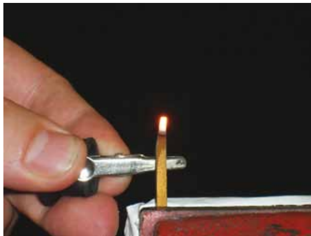
Silka 4: Keramični grelnik, izdelan iz silicijevega nitrida, v katerem so dispergirani prevodni delci ZrN
