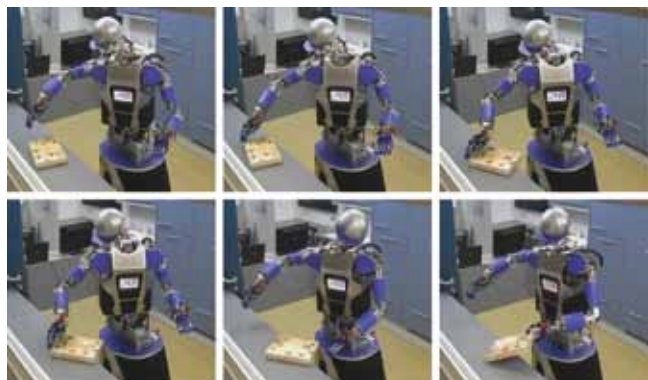
Slika 2: Humanoidni robot potiska objekt zaradi lažjega prijemanja. Akcijo potiskanja se je robot naučil brez predhodnega znanja, samo s samostojnim raziskovanjem v okolju. Eksperiment smo izvedli na Karlsruhe Institute of Technology, Nemčija.
