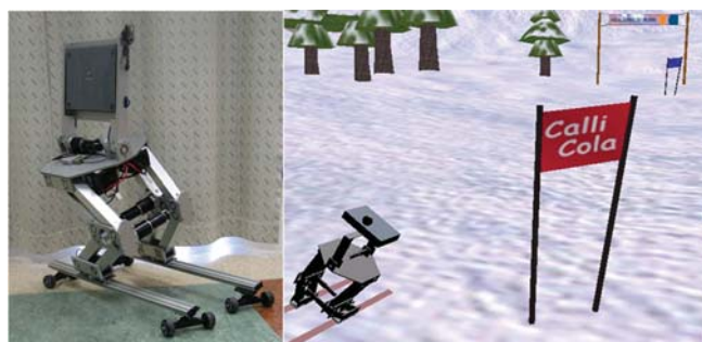
Slika 3: Robot smučar in simulacija smučanja v virtualnem okolju
