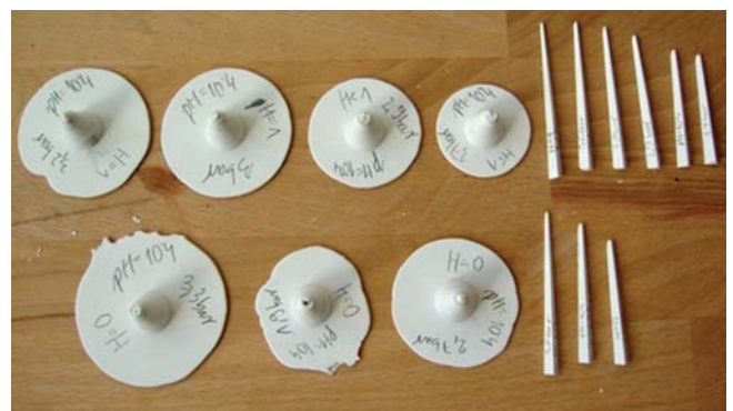
Diski (levo) in stožci (desno), oblikovani z nizkotlačnim brizganjem suspenzije prevlečenega prahu pri pH 10,4, pred vnosom vode (zgornja vrsta) in po njem (spodnja vrsta).
