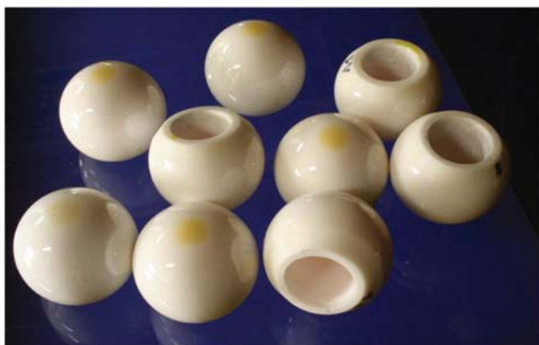
Slika 2: Preskusna serija keramičnih glavic za kolčne proteze z gradientno sestavo. Tehnologija je bila razvita v okviru evropskega projekta BIOGRAD. ( http://cordis.europa.eu/fetch?CALLER=OFFR_TM_EN&ACTION=DE&DOC=2&CAT=OFFR&QUERY=1197645527573&RCN=3420 )
