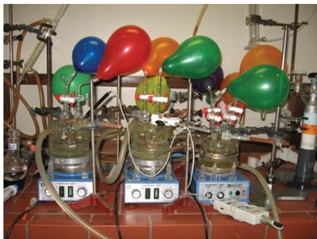
Slika 3: Reakcijske posode za aerobno oksidativno jodiranje organskih spojin. Pri raziskavah "zeleno" kemije je najbolj zaželen oksidant zrak pri zunanjem tlaku. Tako nam baloni rabijo kot shramba zraka za kemijsko reakcijo oksidacije in hkrati za popostritev digestorija.
