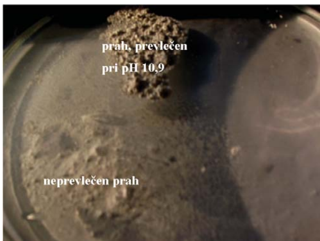
Fotografija prevlečenega in neprevlečenega prahu Al_2O_3 v petrijevki z vodo. V nasprotju z neprevlečenim prahom, ki je omočljiv z vodo, je prevlečen prah (pri pH 10,9) neomočljiv in plava na vodi.
