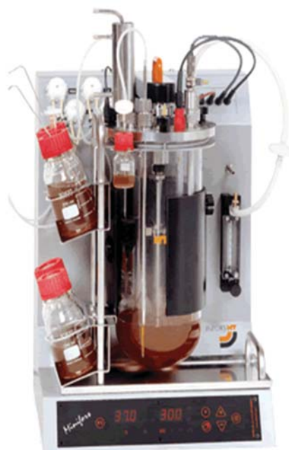
Slika 1: Optimizacija izražanja brazeina je potekala vzporedno na štirih fermentorjih Minifors (ATR Biotech).
