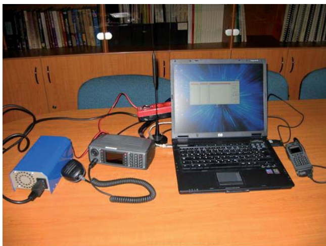
Slika 2: Merilno mesto za ugotavljanje jakosti radijskega signala TETRA
