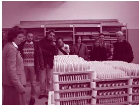
Keramični izdelki po sintranju na keramičnih pladnjih, ki so naloženi drug na drugega in sestavljeni v le na videz nestabilno kompozicijo, nad katero poveznejo peč za sintranje
