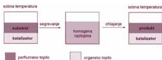
Slika 6: Princip uporabe perfluoriranega topila za bifazno katalizirano reakcijo
