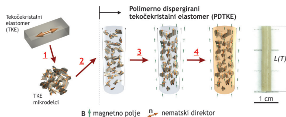
Slika 1: Priprava PDTKE-kompozitov: 1 – mletje, 2 – disperzija delcev v polimerno zmes, 3 – orientacija delcev v zunanjem magnetnem polju, 4 – strjevanje polimerne matrike
