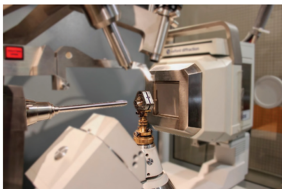
Slika 8: Merrill-Bassett DAC, nameščen na goniometer monokristalnega rentgenskega difraktometra, omogoča določanje kristalne strukture snovi pod visokim pritiskom
