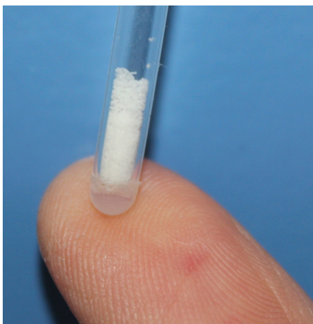
Slika 2: Trden kriptonov difluorid, shranjen v cevki iz fluoriranega etilen-propilena (FEP), z zunanjim premerom 4 mm. Kopolimer tetrafluoroetilena in heksafluoropropilena je odporen material, v katerem je mogoče varno hraniti to agresivno snov in izvajati reakcije z njo.
