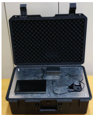
Prenosna naprava za merjenje življenjskega časa fluorescence (avtor dr. Rok Dolenc)
