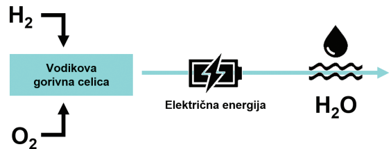
Slika 2: Shematska ponazoritev principa delovanja vodikove gorivne celice s protonsko izmenjevalno membrano
