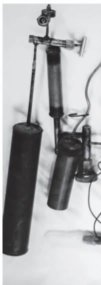
Slika 4: Reakcijska posoda iz niklja – »nikljenica«, v kateri je bil leta 1962 sintetiziran ksenonov tetrafluorid – prva spojina žlahtnega plina v takratni Jugoslaviji.
