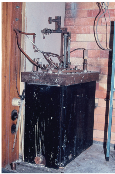
Slika 2: 120-amperska elektrolizna celica za fluor, laboratorij za fluor
