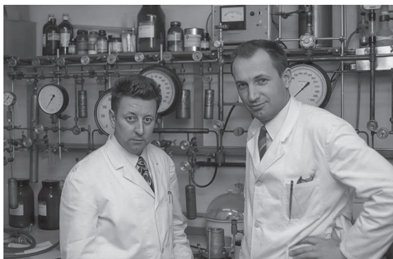
Slika 1: Avtorja prispevka Andrej Šmalc (levo) in Boris Frlec (desno) v laboratoriju ob kovinskem visokovakuumskega sistema za delo s hlapnimi fluoridi
