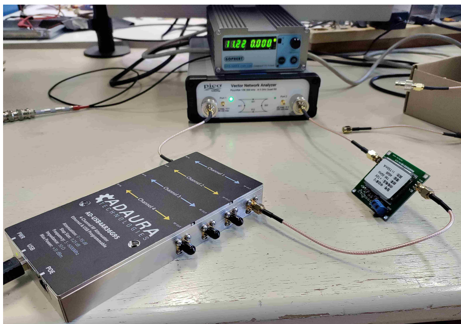
Slika 4.6: Prikaz meritve z analizatorjem. Z dušilnikom smo vhodni signal zmanjšali do te mere, da je bilo maksimalno ojačanje 0 dB. S tem je bilo ojačanje ojačevalca enako dušenju dušilnika.
