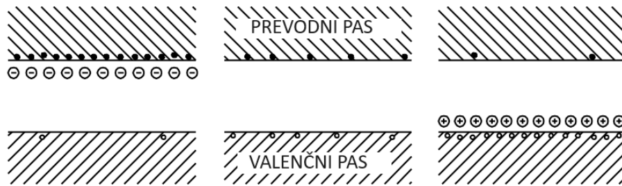
Slika 2.1: Energijski nivoji – na sredini: v čistem polprevodniku; levo: v n-tipu dopiranega polprevodnika, kjer donorji tvorijo nov energijski pas blizu prevodnega; desno: v p-tipu dopiranega polprevodnika, kjer akceptorji tvorijo nov energijski pas blizu valenčnega. Povzeto po [4].
