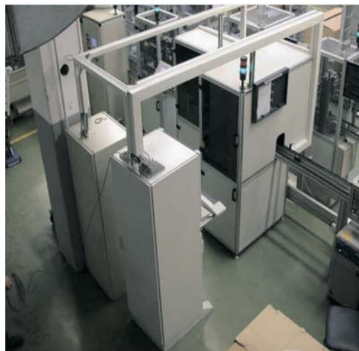
Diagnostična celica za kontrolo kakovosti sesalnih enot na proizvodni liniji (Avtor posnetka: J. Petrovčič)
