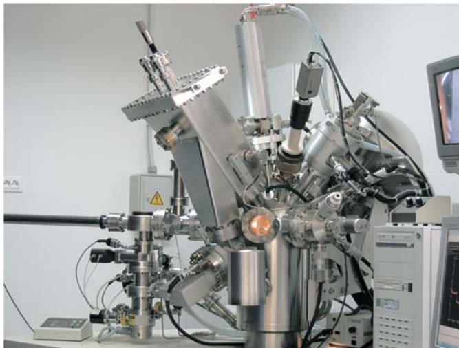
Spektrometer fotoelektronov, vzbujenih z rentgenskimi žarki (XPS) za analizo sestave in kemijskega stanja elementov na površinah in v tankih plasteh. (Avtor posnetka: J. Kováč)
