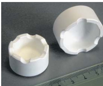
Prototipni batki hidravličnih zavor iz ZTM-keramike (levo) s pripadajočo mikrostrukturo (desno). Bela faza ZrO_2 , siva faza mullit. (Foto: Odsek za inženirsko keramiko)
