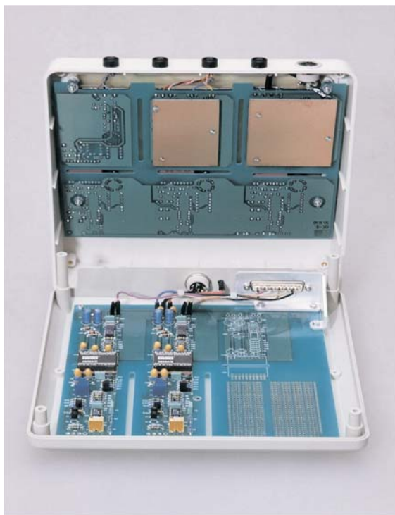
Merilni sistem za pripravo in zajem fizioloških signalov (Avtor posnetka: J. Petrovčič)
